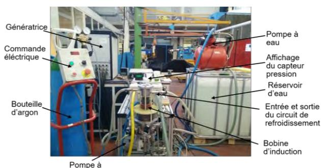
Figure 1- Four à creuset froid adapté à la production d'alliage à haute entropie
