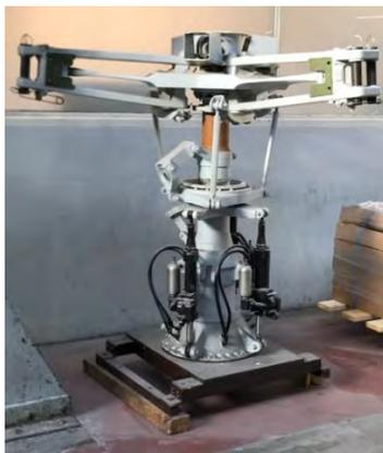
Figure 1: Ensemble rotor et chaîne de commande de vol AS350 – ENSAM Aix-en-Provence
