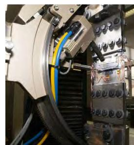
Fig.1. Montage expérimental pour le suivi de l'évolution des contraintes résiduelles de soudage.
