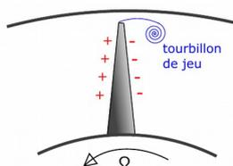
Figure 2: Formation de l'écoulement de jeu
