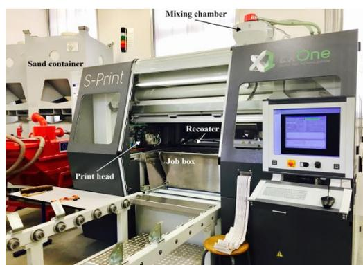
Fig. 1. ExOne 3D Printer.
