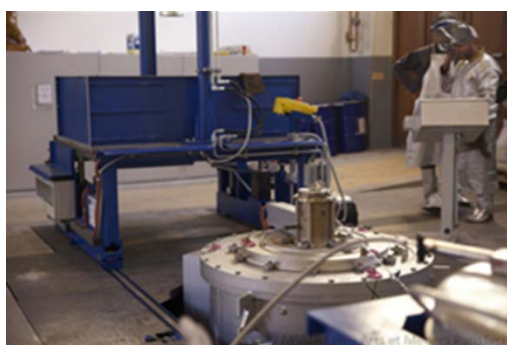
Fig. 1. Four basse-pression de coulée d'alliages de magnésium de la plateforme d'Aix-en-Provence
